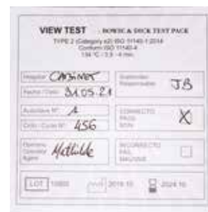
Fig. 2a. Le test Bowie-Dick doit être placé au centre de la cuve de l'autoclave. Il est réalisé avec un programme spécifique à 134 °C pendant 3 minutes et 30 secondes. b, c. Le virage de couleur assure de la réussite du test Bowie-Dick. L'assistant(e) dentaire valide le test Bowie-Dick et archive les données.
