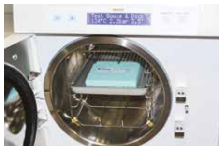
Fig. 2a. Le test Bowie-Dick doit être placé au centre de la cuve de l'autoclave. Il est réalisé avec un programme spécifique à 134 °C pendant 3 minutes et 30 secondes. b, c. Le virage de couleur assure de la réussite du test Bowie-Dick. L'assistant(e) dentaire valide le test Bowie-Dick et archive les données.
