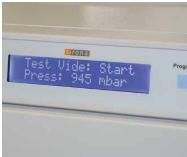
Fig. 1. Le test de vide est paramétré au sein même de l'autoclave. Il ne demande pas d'indicateur colorimétrique.
