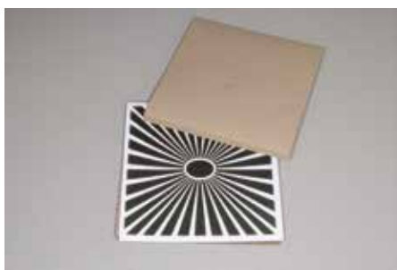
Fig. 2a. Le test Bowie-Dick doit être placé au centre de la cuve de l'autoclave. Il est réalisé avec un programme spécifique à 134 °C pendant 3 minutes et 30 secondes. b, c. Le virage de couleur assure de la réussite du test Bowie-Dick. L'assistant(e) dentaire valide le test Bowie-Dick et archive les données.
