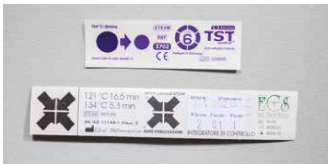
Fig. 5. Les tests biologiques attestent du bon respect des paramètres vapeur d'eau, température et temps.
